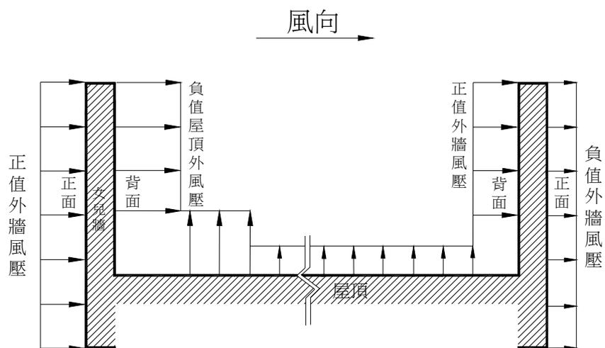
圖 3.4 建築物屋頂女兒牆外風壓分布示意圖
