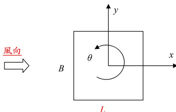
計算順風向加速度、橫風向加速度及扭轉加速度時，僅需考慮回歸期為半年的風速作用下，所產生共振部分風力的影響。令  $D^*$ 、 $L^*$ 、 $\theta^*$  分別是在回歸期為半年的共振部分風力作用下，經結構分析所得建築物最高居室樓層之順風向、橫風向與扭轉向位移，則建築物最高居室樓層形心位置之順風向最大加速度  $A_D$ 、橫風向最大加速度  $A_L$  與扭轉向最大加速度  $A_T$ ，分別為：
